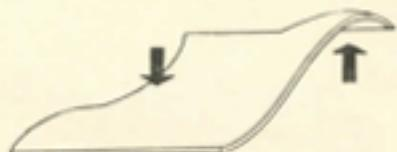
**A chapa plana resiste às cargas principalmente pelo que respeita aos esforços de flexão e torção**
