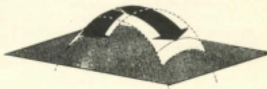
Um conóide é uma superfície regrada formada pelo deslocamento de uma das extremidades de um segmento de recta que se apoia numa curva vertical e a outra numa linha horizontal
