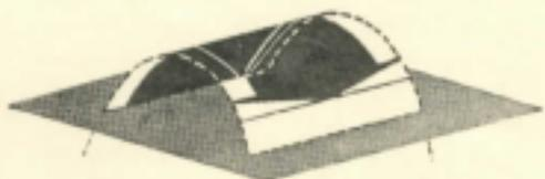
Uma linha horizontal deslizando ao longo de uma curva contida num plano vertical gera uma superfície cilíndrica
