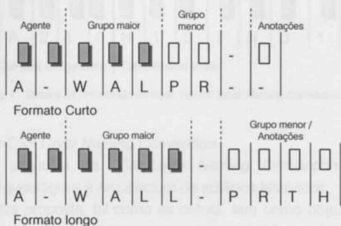
Fig. 5 - Sintaxe de um modelo de layer segundo a norma "AIA CAD LAYER GUIDELINES"
