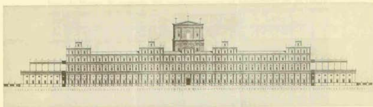
Figura 13. Villalpando: Alzado y sección del templo, con las alturas de los diversos cuerpos proporcionadas para satisfacer el simbolismo numérico que se atribuye al edificio.
